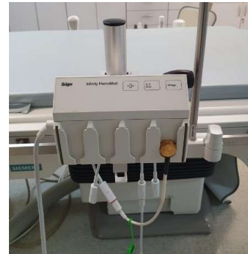
Moduł wejść sygnałów HEMO systemu AXIOM Sensis XP z modułem HEMOMED, mocowane do stołu pacjenta
